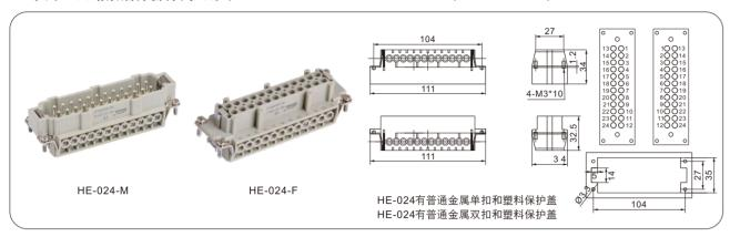
工作电流: 16A 工作电压: 400/500V 阻燃等级(据UL94): V0 防护等级:IP65 接线形式:螺钉压接 弹片压接 冷压针压接 电缆入口可选螺纹: PG21, PG29, M32
