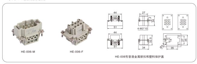
工作电流: 16A 工作电压: 400/500V 阻燃等级(据UL94): V0 防护等级:IP65 接线形式:螺钉压接 弹片压接 冷压针压接 电缆入口可选螺纹: M20, PG16, PG21 Rated current: 16A
