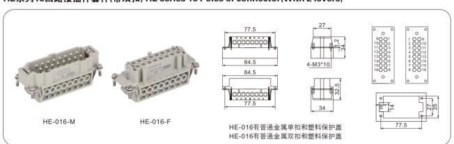
工作电流: 16A 工作电压: 400/500V 阻燃等级(据UL94): V0 防护等级: IP65 接线形式:螺钉压接 弹片压接 冷压针压接 电缆入口可选螺纹: M25, PG21, PG29, M32
